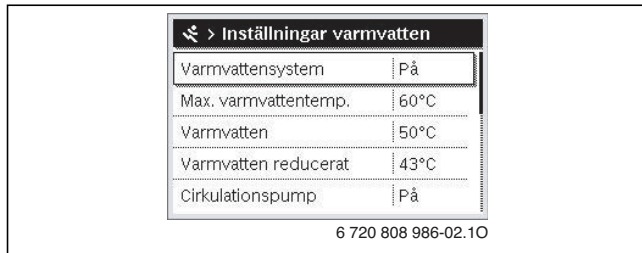
Bild 43 Menyn Inställningar för varmvatten
