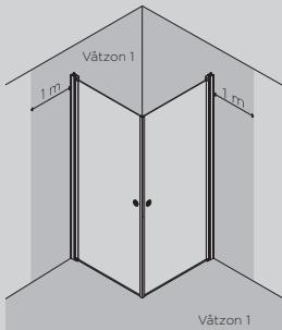
Skruvinfästningar i våtzon 1 ska göras i betong eller annan massiv konstruktion (a), träreglar, träkörningar (b) eller i konstruktion som är provad och godkänd för infästning, till exempel skivkonstruktion (c). Se exempel på godkända konstruktioner på säkervatten.se.
